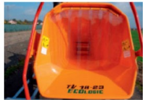
Transparente Klappen im Trichter erhöhen Sicherheit und reduzieren Lärm - Standard auf Motorangetriebene Version EcoLogic.
