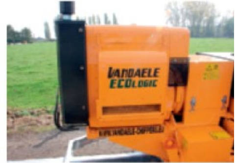
Der Motorgetriebenen Version ist standardmäßig ausgestattet mit ein Hatz-Dieselmotor mit 52 PS, schalldämpft.
