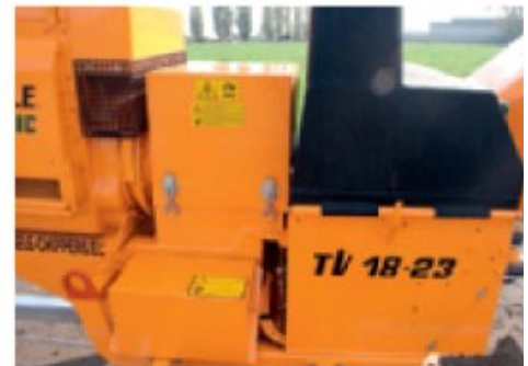
Dieselson: Direktantrieb zwischen Häcksler und Motor ohne Keilriemen oder Schaltgetriebe.
