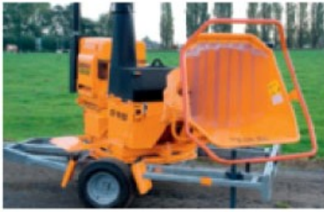
TV18-23 D EcoLogic auf Fahrgestell für den Schnelltransport montierte Option, um 360° schwenkbar.
